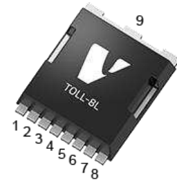
TOLL-8L 1.Gate(G) 2.3.4.5.6.7.8 Source(S) 9.Drain(D)
